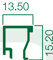
804-22 : คิ้วบานเลื่อนยูโร 80 มม. ร่อง 12 มม.
