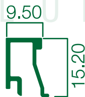
804-23 : คิ้วบานเลื่อนยูโร 80 มม. ร่อง 16 มม.
